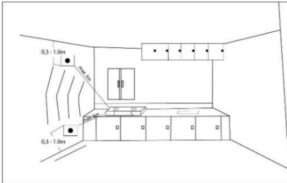
**Plyn lehčí než vzduch:** Detektor umístěte 0,3 – 1m od stropu ve vzdálenosti do 3m od plynového spotřebiče.
