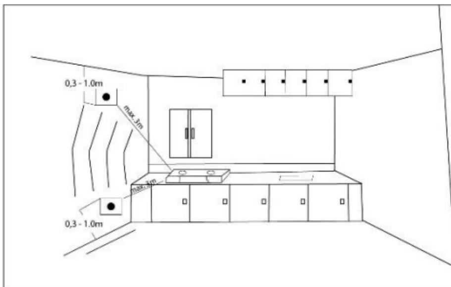
vzduch: Detektor umiestnite 0,3 – 1m od podlahy vo vzdialosti do 3m od plynového spotrebiča.
